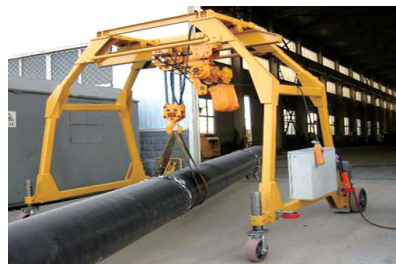
图9 可行走龙门架式运管组对车隧道内施工
