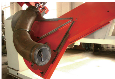
图12 45° 启焊位置 堆焊完成1/8
