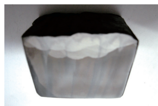
图4 堆焊接头宏观金相
