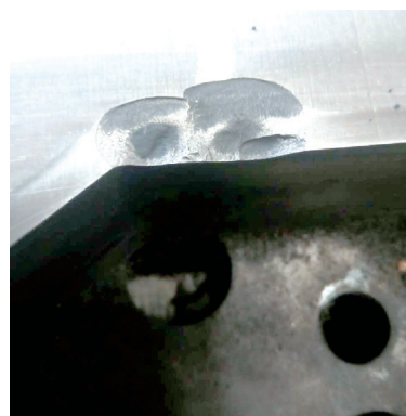
图1 冲头崩损情况
