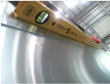
图9 窗框直线度测量
