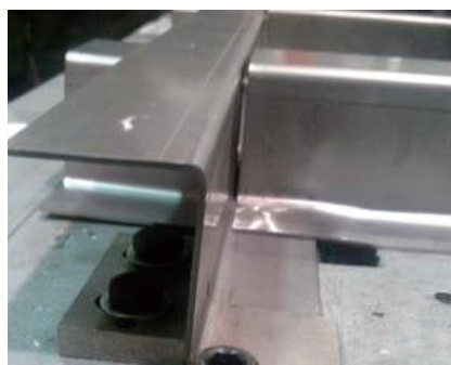
图4 侧墙连接立柱垂直度、上下平面平行度尺寸超差
