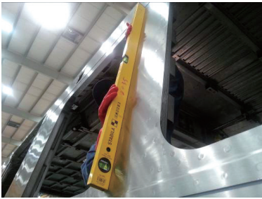
图9 窗框直线度测量
