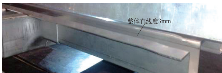
图7 侧墙骨架横向与纵向整体平面度有3mm偏差
