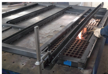
图1 南非车变流器箱体侧板组件火焰矫正夹紧
