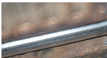
图5 高脉冲焊接焊缝外观
