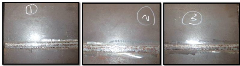
图2 混合气体焊接外观
