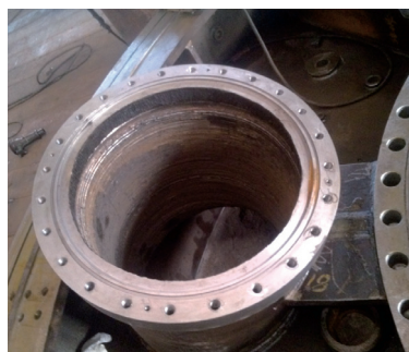
图4 螺旋输送机焊后最终状态
