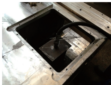
图2 超声波探伤和腐蚀照片
