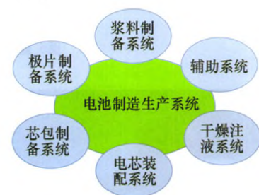
图5 锂电池的制造生产系统
