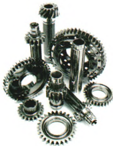
图3 喷丸强化处理后的齿轮和齿轴
