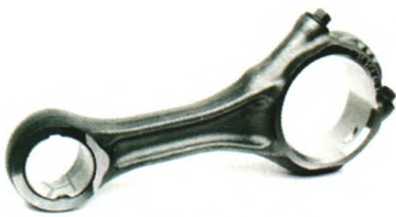
图1 喷丸强化处理后的连杆
