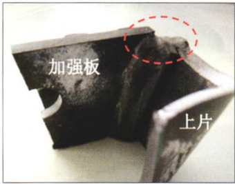
图6 断口取样位置示意
