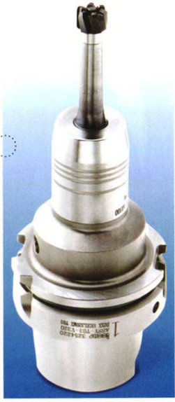
图4 卡口式铰刀（BAYO T-REAM）用于加工蝶形阀衬套孔
