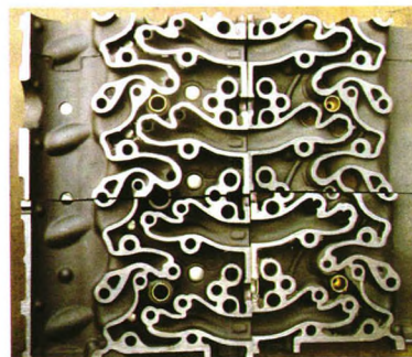
图1 整个缸盖的水套形状
