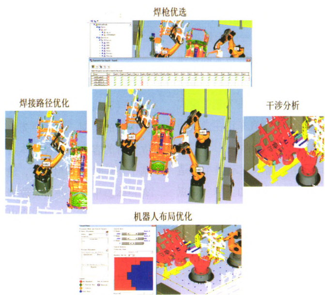
图7 长安汽车数字化工厂三维布局模型
