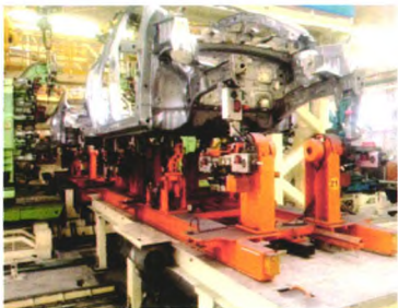
图7 辊床台车输送系统
