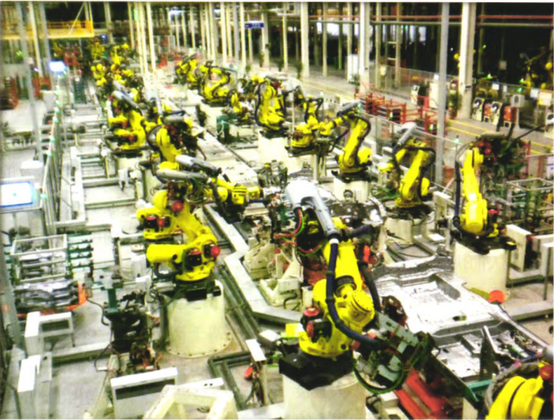
图1 江淮瑞风S3焊装线
