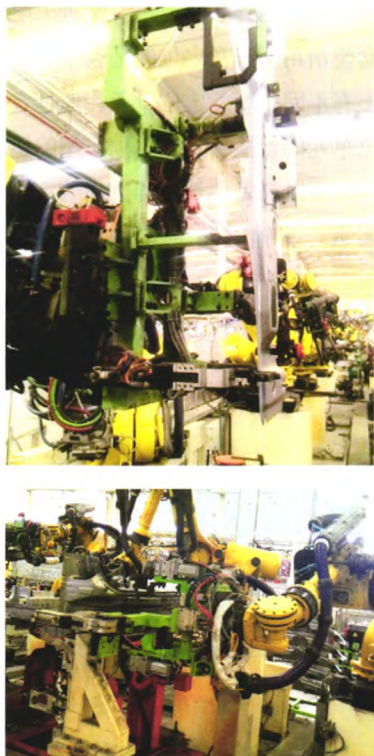
图3 机器人抓具定位系统
