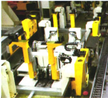
图6 NC-LOCATOR定位系统
