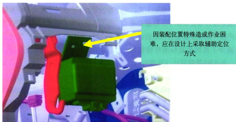
图6 助力转向ECU装配分析
