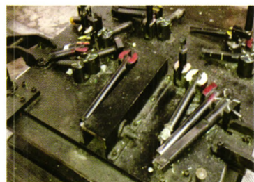
(b) 前后悬合装工装磨损严重 1.AGV小车 2.前后悬合装工装 3.前后悬总成 图 1
