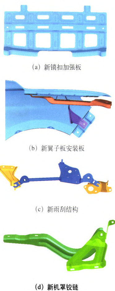
图5 改进后的车型结构
