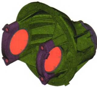
图4 减速器壳有限元模型 减速器壳材料QT450，屈服强度为310MPa，弹性模量为147 GPa，泊松比0.25，密度7 300 kg/m 3 。
