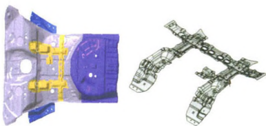
图3 后地板面板结构
