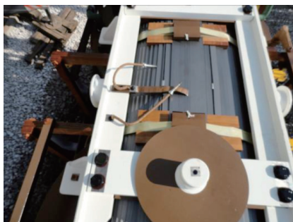
(a) 夹件引线绝缘及上部定位内部结构
