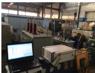
图2 负载试验下绕组振动数据采集现场
