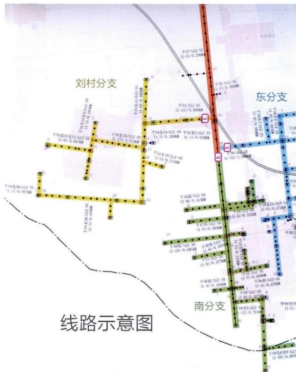
图3 监控供电线路结构
