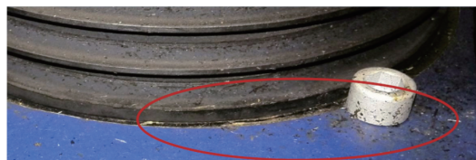
图6 大面积齿面脱落
