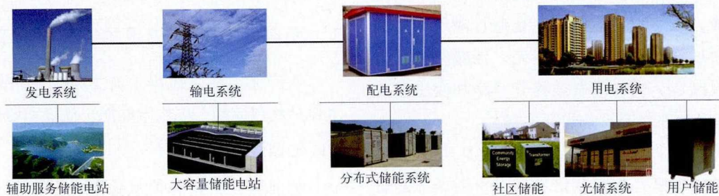
图1 储能在电力系统中的应用示意图
