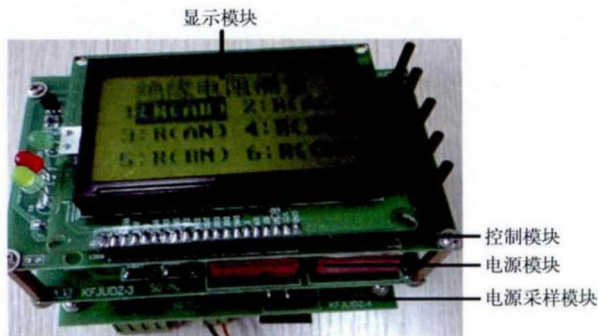
图4 绝缘电阻测量系统实物图
