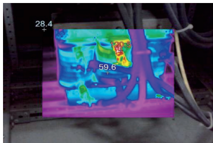
图3 变频器红外热成像
