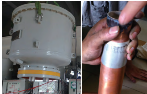
图8 B相连接导杆端部烧蚀
