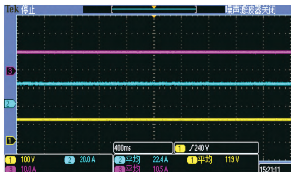
图8 两组蓄电池的电流和母线电压波形
