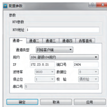
图4 调度主站模拟系统配置图
