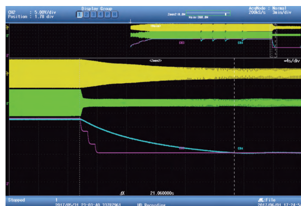
图4 FCB从50.00 Hz快速制动到15.00 Hz的过程, 用时21 s
