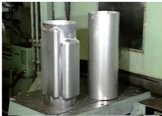
图2 圆筒(壳体)胀形前后的对比
