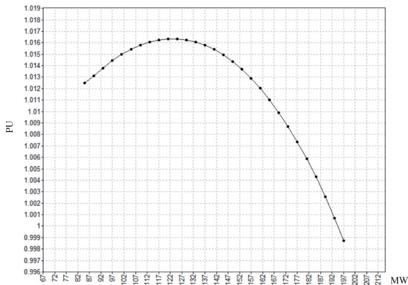
图5 IEEE 9节点标准网络PV曲线示意图
