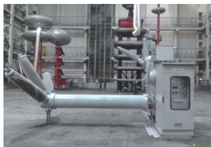
图5 145 kV GIS绝缘型式试验样机布置
