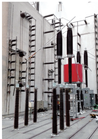
图8 并联两柱均流开断试验
