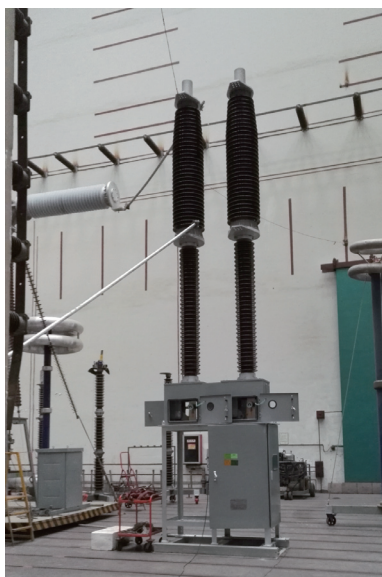
图6 单柱T100s试验
