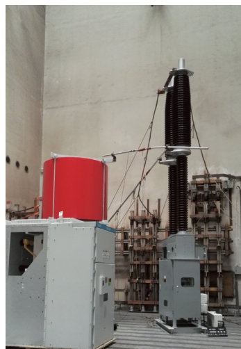
图7 动、热稳定试验
