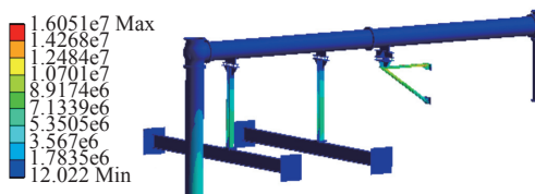
图6 Y+Z向地震作用下结构应力图(单位:Pa)
