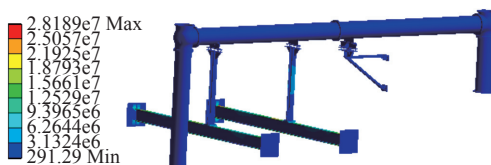
图4 X+Z向地震作用下结构应力图(单位:Pa)
