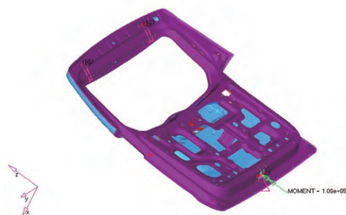
图4 尾门扭转刚度分析约束和载荷模型
