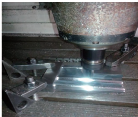
图 9 粗加工热处理后的状态
