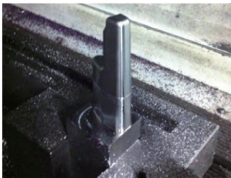
图 29 热处理后第一次装夹精加工
