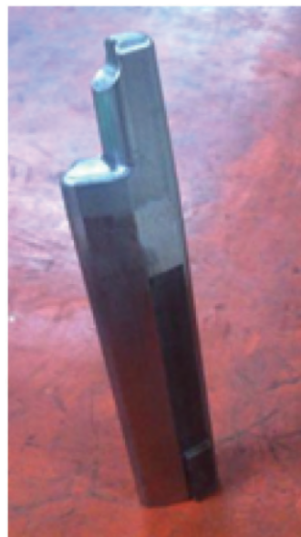
图 34 线切割切除工艺装夹部分
