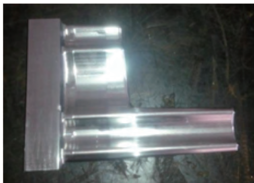
图 11 精加工结束后的状态
