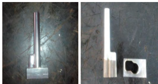
图 6 精加工与线切割后的状态
