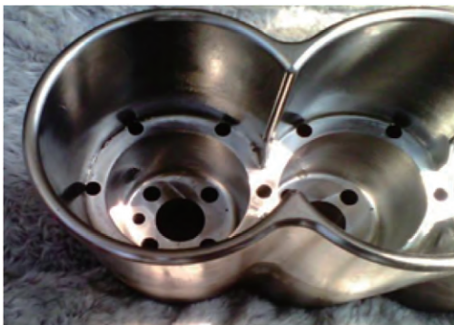
图 22 镶件线切割结束后的状态
