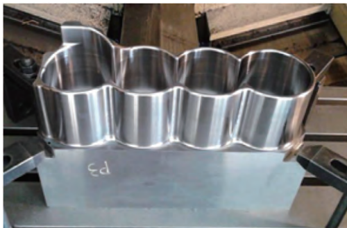
图 21 精加工结束前在机床上的状态
