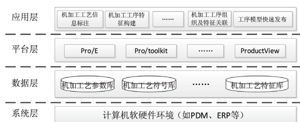
图7 三维机加工工艺设计技术架构图
