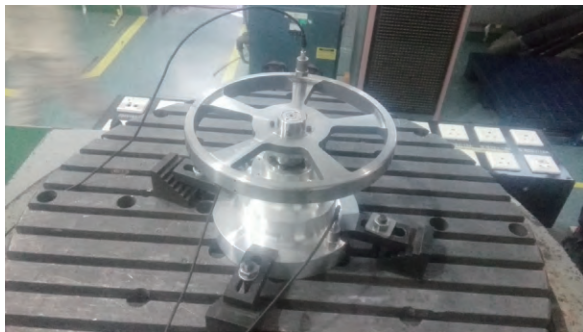
图4 某滚动轴承转子系统振动现场图
