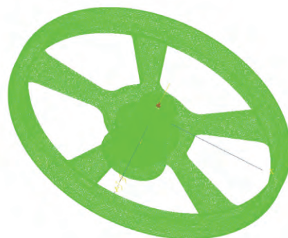
图 2 某滚动轴承—转子系统有限元模型
