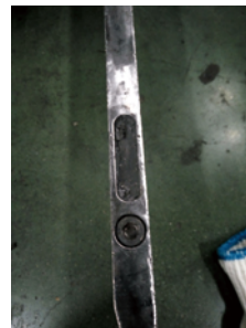
图4 已植入 RFID 标签的口型板
