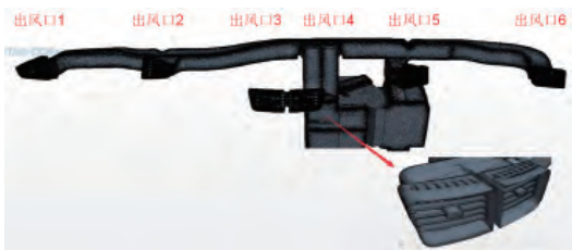
图2 CFD 网格模型网格
