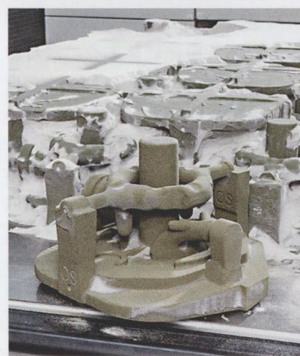
图 2 采用 3D 打印技术生产的定制铸芯，为 Bosch Rexroth 铸造厂生产个性化铸件和小批量加工节约了成本和供货时间
