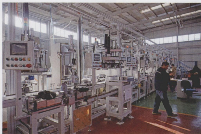
图2 绅名科技提供的自动化装配线由 22 台设备组成
