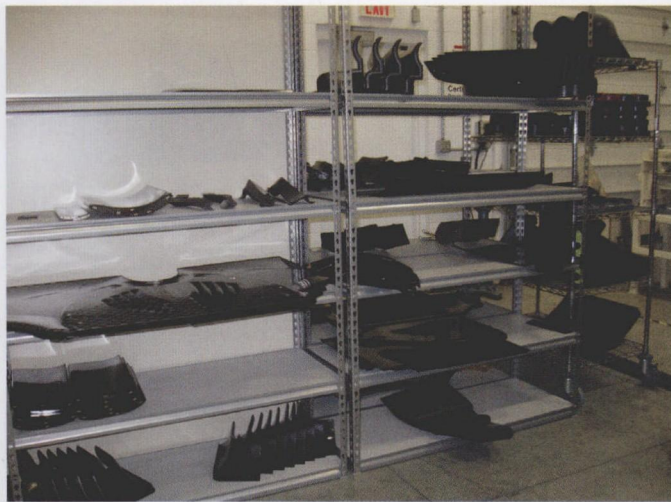
图5 数控路由器上的这些零件现在已经过铣削、钻孔和修整
