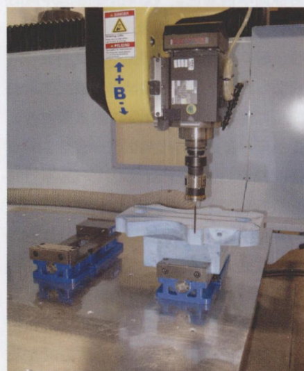
图 1 探测针被用来定位廉价夹具，该探测针专为复合材料加工而制造
