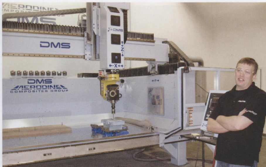
Kyle Castor 负责监督五轴槽刨机的工作。购置这台机床的目的是使用其设计图案，能节省软件工具设置的成本，该机床成为了用于加工复合零件的一种资源
