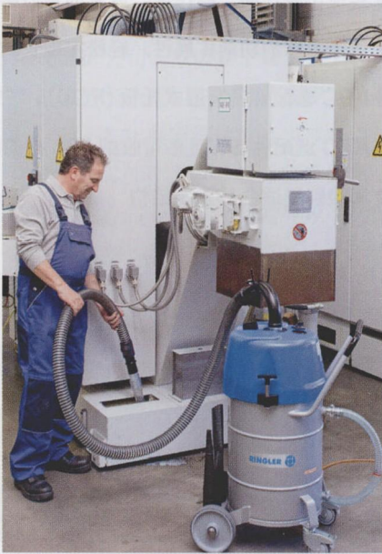
图 1 移动式抽吸器可以很灵活地应用于多个工位上
