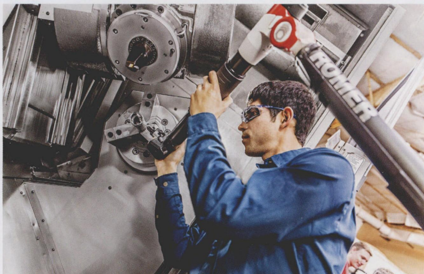
图4 沃尔夫勒姆公司的 Robert Perez 使用便携式 CMM 来检查机床中的最终产品
