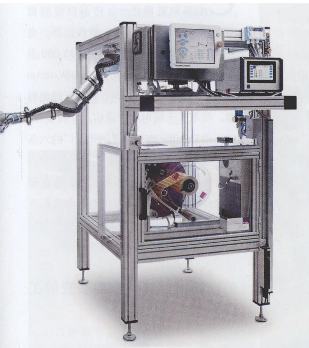
图 1 为了能够确保客户企业实现无可挑剔的生产流，Topex 公司研发的标签打印装置装有若干协作进行作业的 UR 机器人
