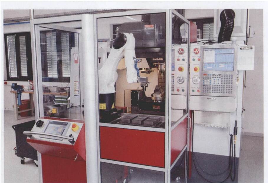
图 1 Dannoritzer Medizintechnik 工厂的加工中心里，库卡 KR AGILUS 型机器人在移动机器人单元中工作可靠地保障了上料卸料过程，而且具备极大的灵活性
