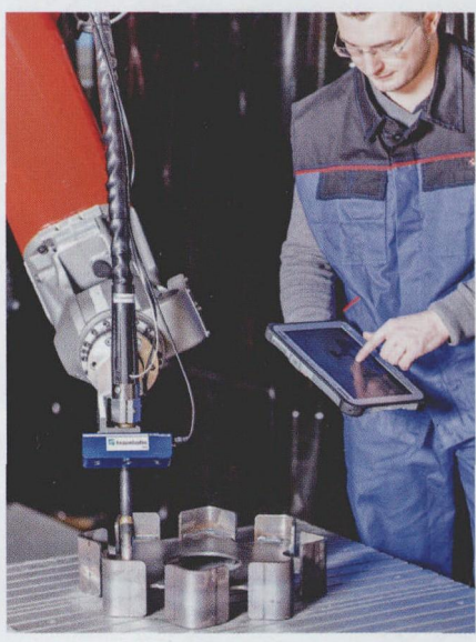
图 5 一个 MRK (人 - 机器人 - 合作) 交互类型的实例: 通过一名工人直接设定动作
