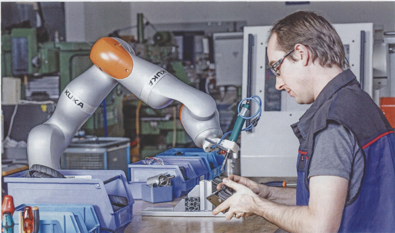
图 1 人 - 机器人 - 合作 (MRK) 交互类型的一个实例：在加工作业中，机器人作为操作人员的第三只手使用
